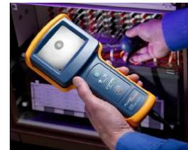
*A inspeção da terminação, utilizando um microscópio óptico portátil ou um videomicroscópio (ilustrado aqui) deve ser realizada durante e após a terminação, a fim de verificar se as terminações do conector estão contaminadas ou com polimento inadequado.*
